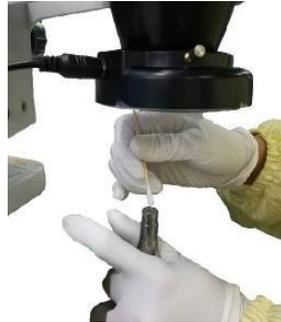
2. 清洁干净的加工头，请确认加工头镜片干净无污染，加工头内壁无附着灰尘。
