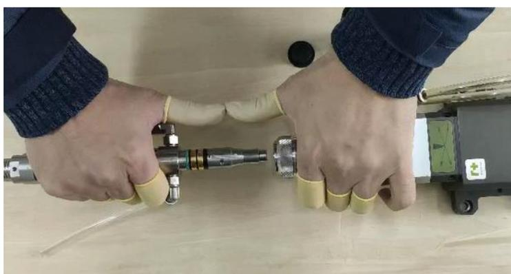
注意：安装时应同时注意光纤的弯曲半径不应低于限定值（最小弯曲半径 400mm）。
