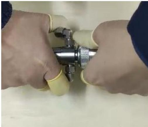
2 拔出 QBH 输出头，盖上 QBH 输出头的保护帽；
