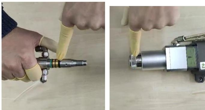
4 安装时一定要慢慢地将 QBH 输出头插入加工头的连接器，以免磕碰损坏；
